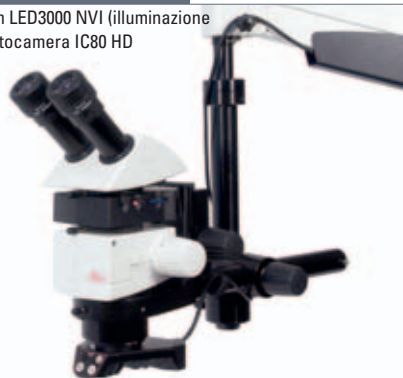
Leica Serie S con combi controller LED1000 High Power Spot e braccio di messa a fuoco
