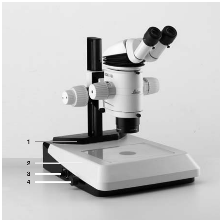
Joonis 1. Leica MZ125 ErgoTube™ tuubusega, jäme/peenajamiga ja TL ST läbiva valguse alusega
