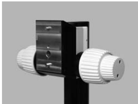
Rys. 3 Adapter pomiędzy napędem ogniskowania i przystawką mikroskopu
