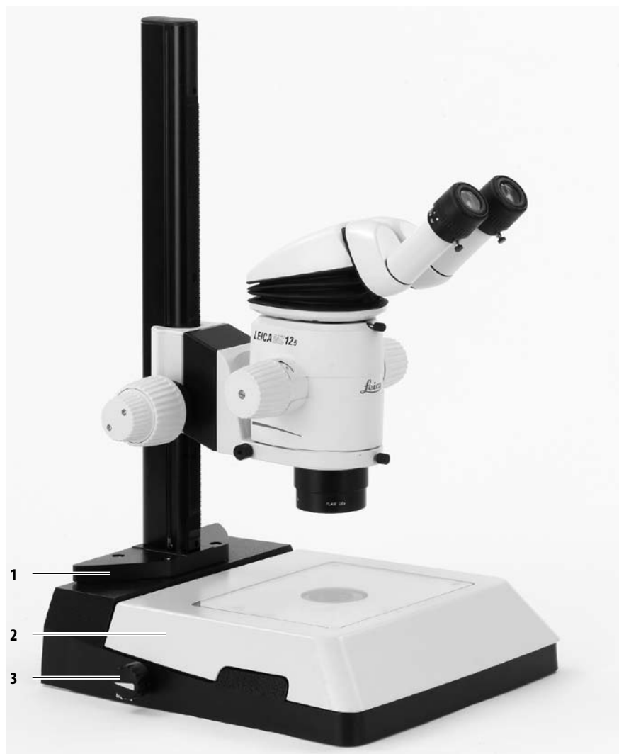
Σχ. 1 Leica MZ16 με ErgoTube™, προσεγγιστική/λεπτομερή ρύθμιση, βάση διερχόμενου φωτός TL BFDf, Τυπική τράπεζα και 4<math>\times</math>αντικειμενοφόρες πλάκες
