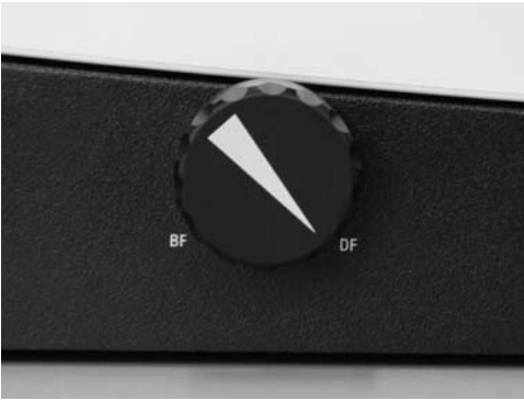
Fig. 4 Botón para el cambio de campo claro a campo oscuro (aquí: botón en posición de campo oscuro)
