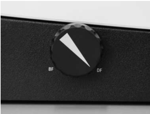
4. ábra A világos- és sötétterű vizsgálatok közti váltógomb (az ábrán sötétlátóteres állásban)
