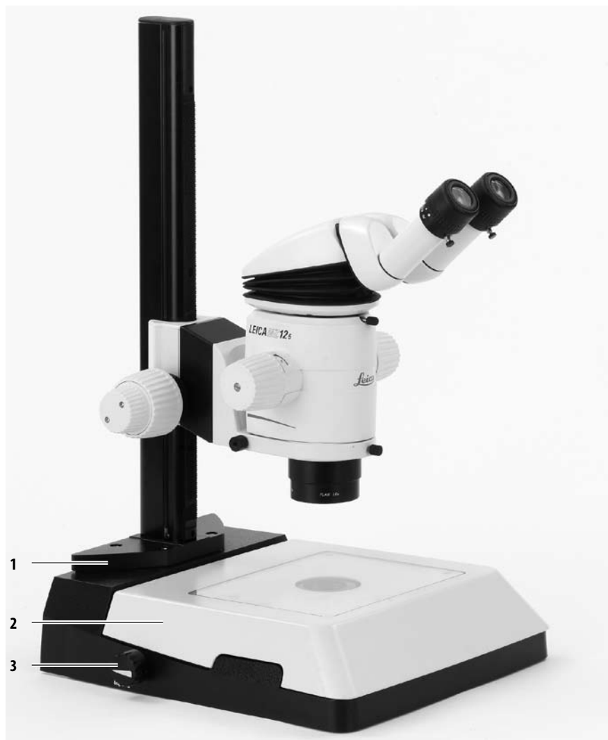
1 pav. Leica MZ16 su ErgoTube™, bendro/tikslaus fokusavimo mechanizmu, sklaidžiamosios šviesos pagrindu TL BFDf, standartiniu objektiniu staliuku ir 4×stikleliais
