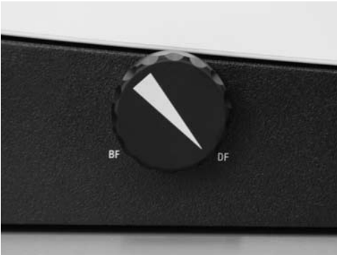
Afb. 4 Knop voor wisselen helderveld/donkerveld (hier: knop in positie voor donkerveld)
