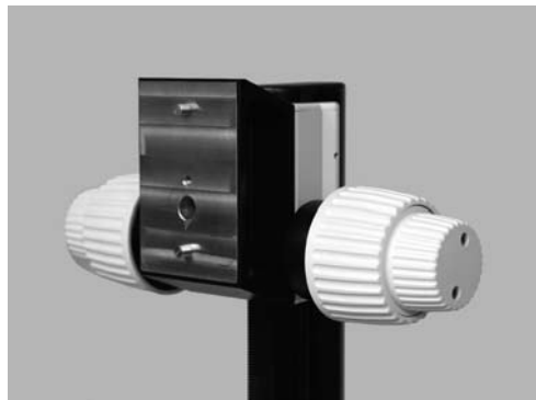
Fig. 3 Adaptador no mecanismo de focagem
