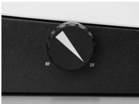
Obr. 4 Gombík na prepínanie medzi svetlým/tmavým polom (tu: gombík v polohe tmavého poľa)
