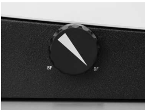
SI. 4 Gumb za preklon med svetlim vidnim poljem in temnim vidnim poljem (slika: gumb v položaju za temno vidno polje)
