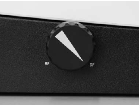
Bild 4 Ratt för byte mellan ljusfält/mörkerfält (här är ratten vriden till mörkerfältspositionen)
