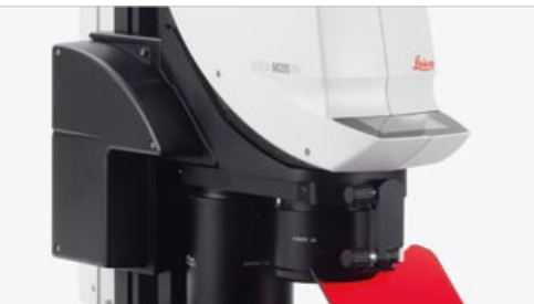
Réglages du zoom rapides, précis et reproductibles grâce à la nouvelle MAP motorisée
