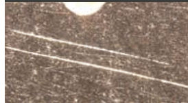
マルチコントラストで観察したクラック
