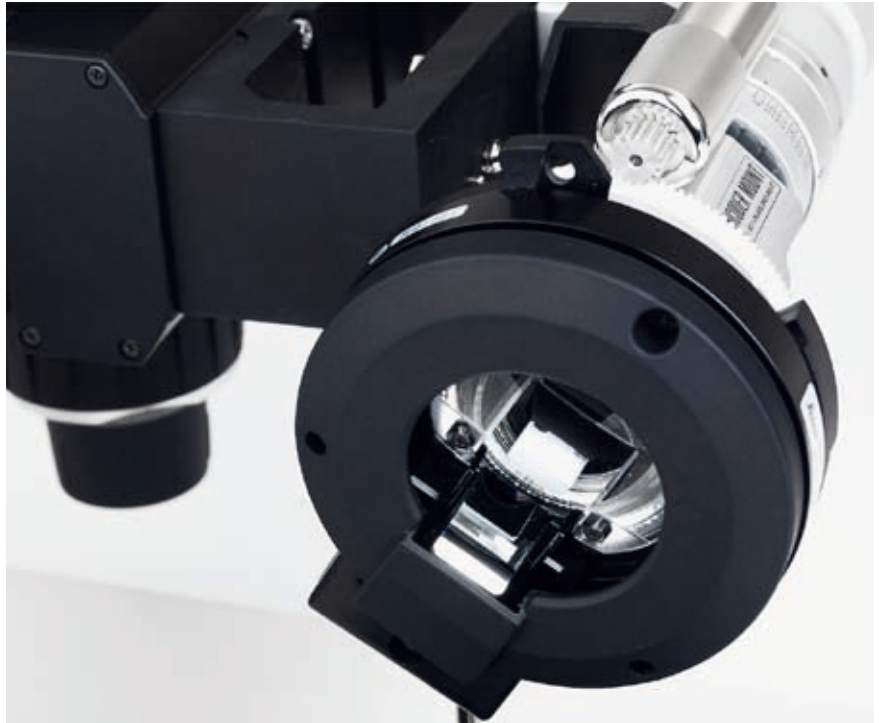
Abb. 2: Der 360°-Drehkopf liefert eine Rundumsicht der Probe, die ganz neuartige Betrachtungsmöglichkeiten eröffnet. Als Nebeneffekt des sich drehenden Bildes erhält der Anwender einen realistischen Eindruck der Dreidimensionalität der Probe.
