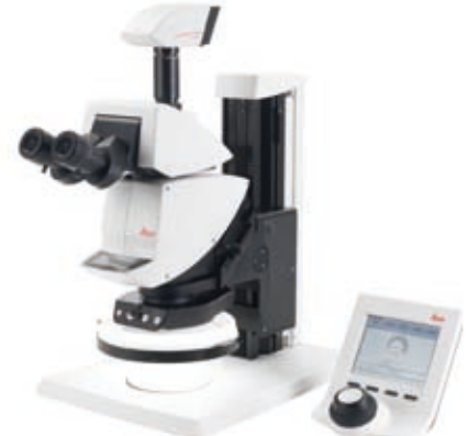
Abb. 3: Leica FlexiDome™ in oberer Position: maximale Zugänglichkeit zur Probe. Die Lichtcharakteristik entspricht einer Neonkreisleuchte.
