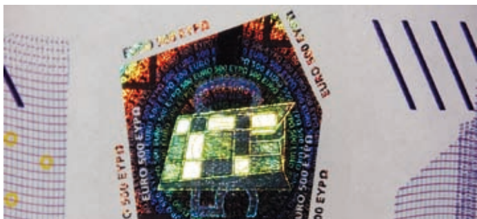
Abb. 3: Folienelement der 500 Euro-Note, aufgenommen mit dem Schwenkstativ des Digitalmikroskops in einem Winkel von ca. 45°
