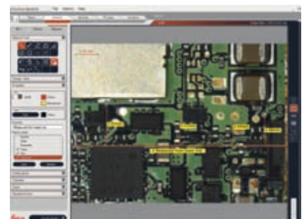
Abb. 7: LAS – messen ohne Grenzen: Das Messmodul der Leica Application Suite (LAS) ermöglicht vielfältige Auswertungen – von einfachen Punkt-zu-Punkt-Messungen bis zu intelligenten Bilderkennungs-Algorithmen. Mit dem LAS-Messmodul können unter anderem automatische Bildanalysen zur Bestimmung von Phasenteilen, Korngrößen, Partikeln durchgeführt werden.
