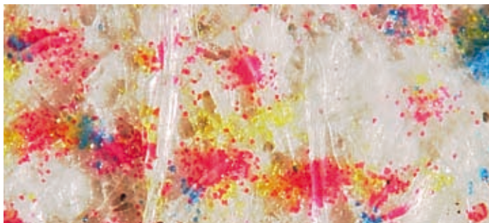
Abb. 5: Tonerpartikel und Papierfasern einer Fälschung
