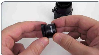
3. Revissez l'insert pourvu du réticule et replacez l'oculaire dans le tube.
