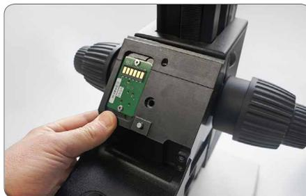
3. Appuyez le Leica LED5000 NVI vers l'arrière contre la colonne de mise au point et vissez-le bien avec une clé pour vis à six pans creux M4.
