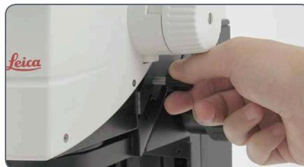
2. Faites glisser le microscope en position de base (centrale) afin d'obtenir une représentation spatiale et serrez la vis.
