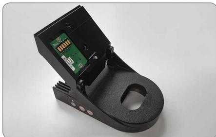
2. Posez le Leica LED5000 NVI sur la colonne de mise au point, de façon à faire correspondre la vis au filetage prévu à cet effet, et l'ergot à la rainure.
