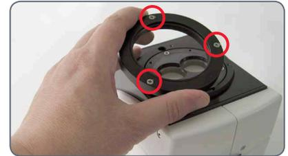
5. Montez le corps de microscope sur le porte-microscope AX.
