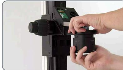
4. Desserrez les trois vis d'arrêt et enlevez la bague d'ajustement du corps de microscope.
