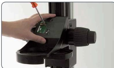
3. Desserrez les trois vis à empreinte cruciforme situées sur la monture d'objectif du corps de microscope et retirez la bague intermédiaire.
