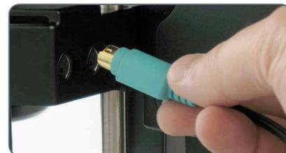
3. Branchez l'autre extrémité du câble sur l'un des trois ports "CTL2" de la colonne.
