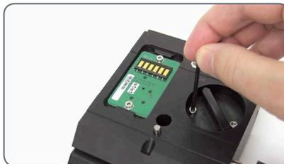
3. Retirez le commutateur, mettez-le à la position souhaitée en effectuant une rotation et réinstallez-le.
