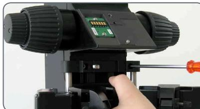
2. Connectez le câble CAN-Bus fourni à l'une des deux prises. (La partie plate du connecteur doit être orientée vers le bas.)
