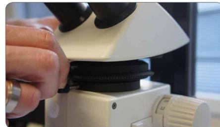
3. Pour créer l'effet de polarisation souhaité, tournez le disque rotatif de l'analyseur jusqu'à l'obtention de la qualité d'image souhaitée.
