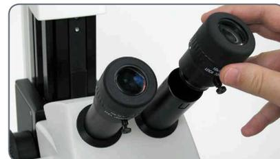
4. Serrez les vis de fixation.
