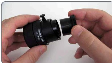
4. Vous pouvez maintenant orienter le réticule en tournant l'oculaire dans le tube oculaire et le fixer ensuite avec la vis.
