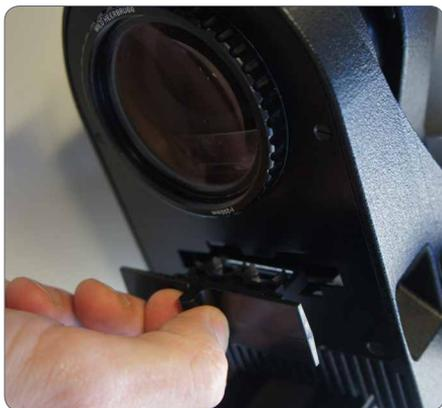
2. L'analyseur se monte entre le tube et le corps de microscope. Pour ce faire, démontez le tube installé sur le corps de microscope. Placez l'analyseur sur le corps de microscope et montez ensuite le tube. Fixez les composants en vissant les vis d'orientation.
