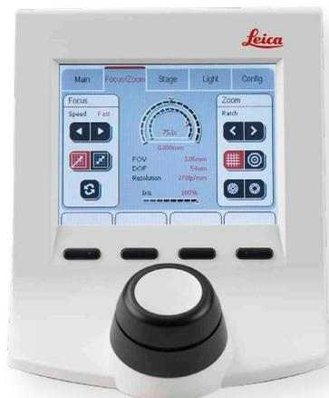
L'écran tactile de Leica SmartTouch vous permet de commander en quelques gestes le déroulement de vos essais sans jamais perdre de vue les paramètres optiques essentiels.
