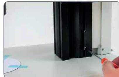
3. Empurre a parada limite para a altura do foco motorizado.
