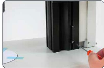
3. 将限位止挡推至电动对焦装置所处高度。
