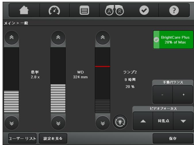
ライトケアプラスを有効にすると、現在の作動距離で設定可能な輝度の上限を示す赤い線が輝度調節バー上に表示されます。
