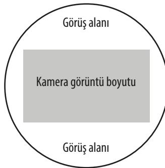
Şekil, görsel video kamerası ve Leica FL800 ULT NIR kamera için kamera görüntü boyutunu görüntü alanına göre gösterir. Görüş alanı, dokümantasyon sisteminin tam kapsamı içinde değildir.
