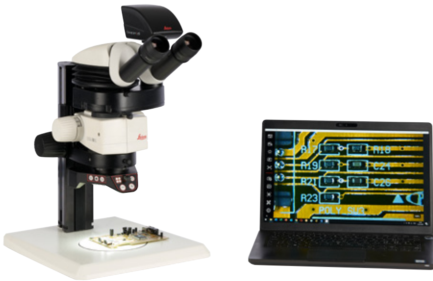
Cámara Flexacam c5 con microscopio estereoscópico M60 utilizando la aplicación de escritorio de la plataforma de software Enersight.
