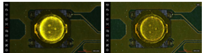
Izquierda: Imagen de un componente electrónico sin HDR Derecha: Imagen de un componente electrónico con HDR
