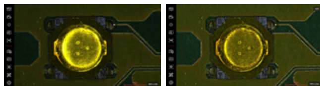
A sinistra: immagine di un componente elettronico senza HDR A destra: immagine di un componente elettronico in HDR
