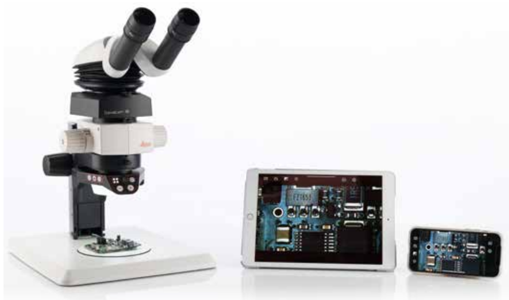
Enersight 모바일 앱을 사용하는 M50 실체 현미경을 장착한 Flexacam i5 카메라.
