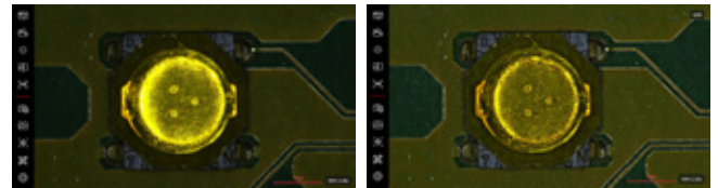
Esquerda: Imagem de um componente eletrônico sem HDR Direita: Imagem de um componente eletrônico com HDR
