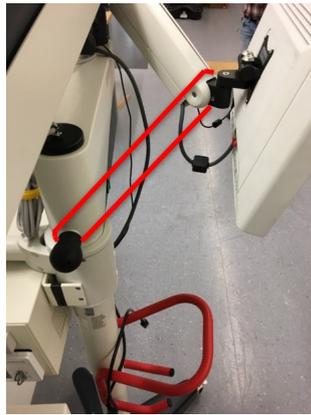
Abb. 3 - Gurtbefestigung des Monitors
