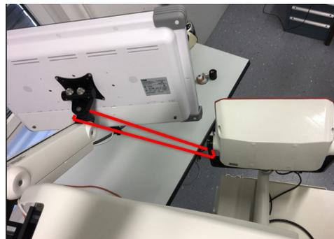
Abb. 6 - Gurtbefestigung des Monitors
