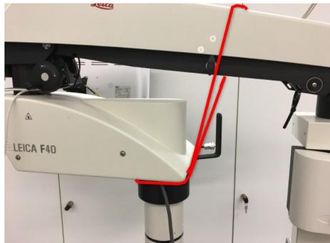
Abb. 5 - Gurtbefestigung des Parallelogramms
