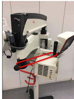
Figura 4 - Cinta de fixação da unidade de controle
