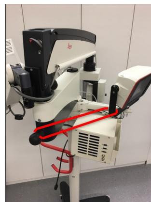
Рис. 4. Крепежный ремень для блока управления
