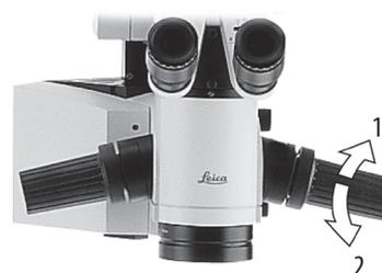
**⚠** Если индивидуальная конфигурация для текущего пользователя отсутствует, тормоза разблокируются путем поворота рукояток следующим образом.
