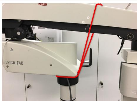
Рис. 5. Крепежный ремень для параллелограмма
