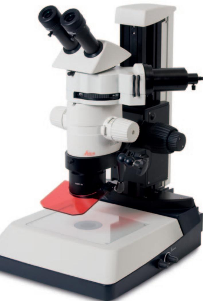
Microscopio stereoscopico a fluorescenza Leica MZ10 F con illuminazione EL6000
