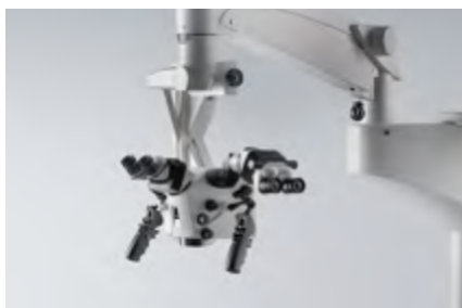
主镜多角度倾斜和移动
