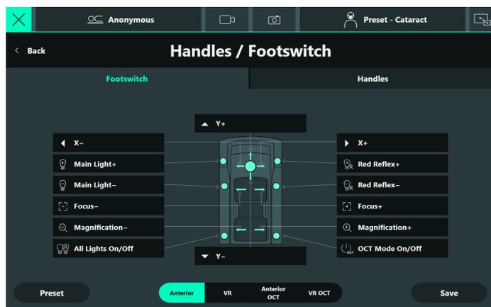
! Le récepteur sans fil de la pédale intégrée est Principale, la pédale en option insérée est Secondaire. Il est seulement possible d'utiliser une commande à pédale à la fois (voir chapitre 9.17.5 "Config. microscope", page 61).
