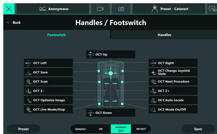
Sie können vom anterioren Modus zum OCT-Modus wechseln. Zum Umschalten von der "anterioren" Belegung zu OCT am Fußschalter müssen folgende Bedingungen erfüllt sein:
