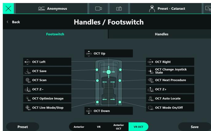
Вы можете переключать ножной переключатель с режима VR на режим VR OCT. Для переключения ножного переключателя с режима VR на режим OCT должны быть выполнены следующие условия:
