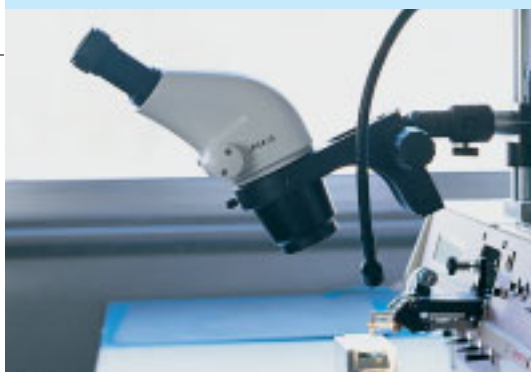
ライカ S6(観察角度60°)をフォーカスドライブに装着、傾斜、OEM仕様
