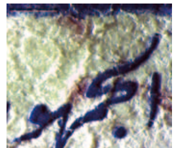
Abb. 6: Bei diesem echten Tiefdruck ist der erhobene Farbauftrag gut zu erkennen.
