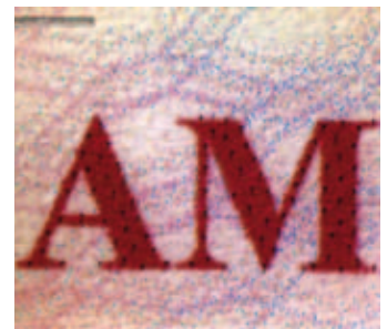
Abb. 4: Diese Seriennummer wurde mit einem gewöhnlichen Tintenstrahldrucker aufgebracht. Mit bloßem Augen wäre das nicht eindeutig erkennbar.
