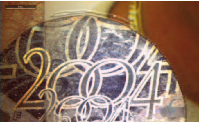
Abb. 2: Ein nachträglich eingesetztes Hologramm, dessen Ränder unter dem Mikroskop eindeutig erkennbar sind.
