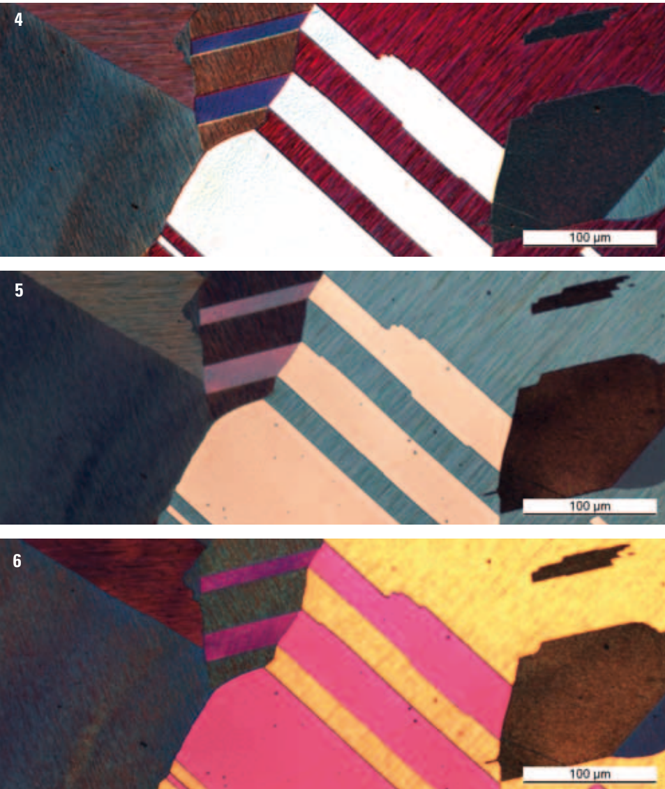
Abb. 4 – 6: Aufnahmen eines kfz-Gitters einer Kupferlegierung mit Polarisation und unterschiedlichen Winkeln.
