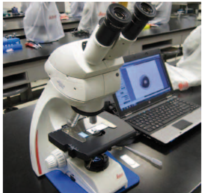
Abb. 2: Die Arbeitsstation ist mit einem Leica DM750, einer Mikroskopkamera Leica ICC50 HD sowie einem Laptop ausgestattet.
