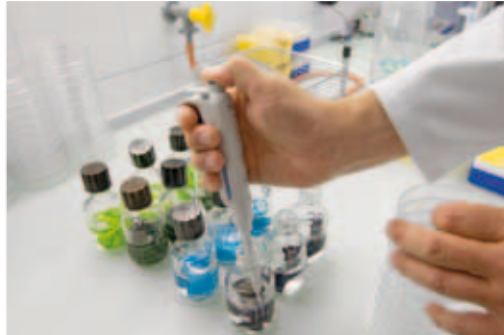
Abb. 4: Um die genaue Keimzahl zu bestimmen, werden mit der Mikropipette die Verdünnungsreihen ausgeplattet.
