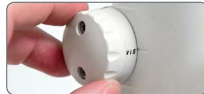
2. Para el ocular ajustable, gire la corrección de dioptrías hasta la posición central.
