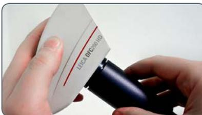
3. Coloque la unidad en la salida para vídeo/fotografía del microscopio estereoscópico y atorníllela.
