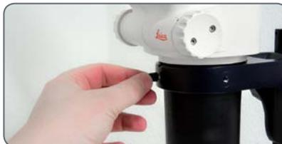
2. Gire el portaóptica lateralmente hasta la posición deseada.
