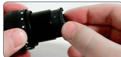
5. Introduzca el ocular en el tubo y oriente el retículo girando el ocular en el tubo.
