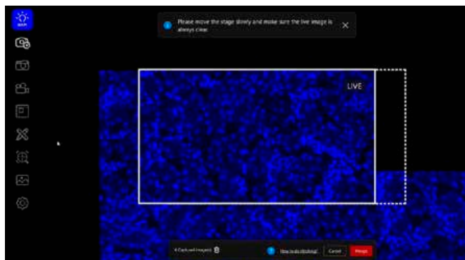
La función de cosido XY permite observar una zona más amplia de una muestra con mayor resolución.
