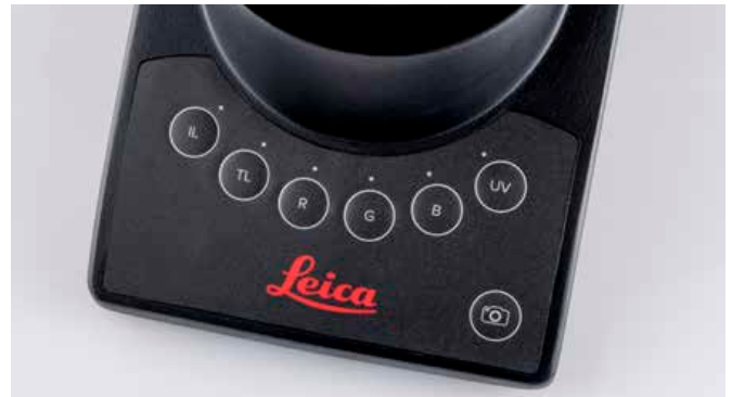
Ahorre tiempo y trabajo capturando su imagen con solo pulsar un botón en la base del microscopio.
