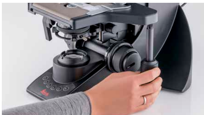
La mandos de la platina XY y el enfoque son de fácil de acceso y se pueden ajustar con una mano.
