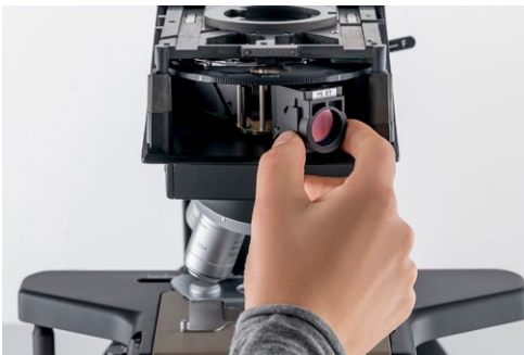
Fig. 22 Montarea cubului filtru
