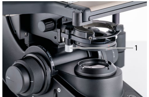
Fig. 24 Montarea suportului polarizatorului *
