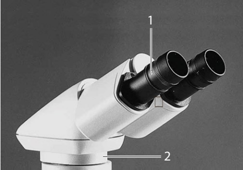
Fig. 41 Reglarea tubului 1 Scală (mm) 2 Modul intermediar*, în ilustrație: Modul Ergo
