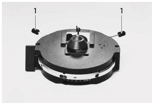
Fig. 33 Centrarea inelului de lumină (de ex.: condensator UCA/P)
