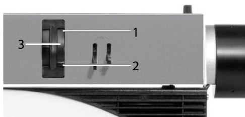
Fig. 52 Elementi di comando per illuminazione obliqua
