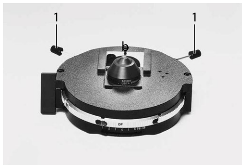
Fig. 36 Centraggio dell'anello luminoso (vale a dire: condensatore UCA/P)
