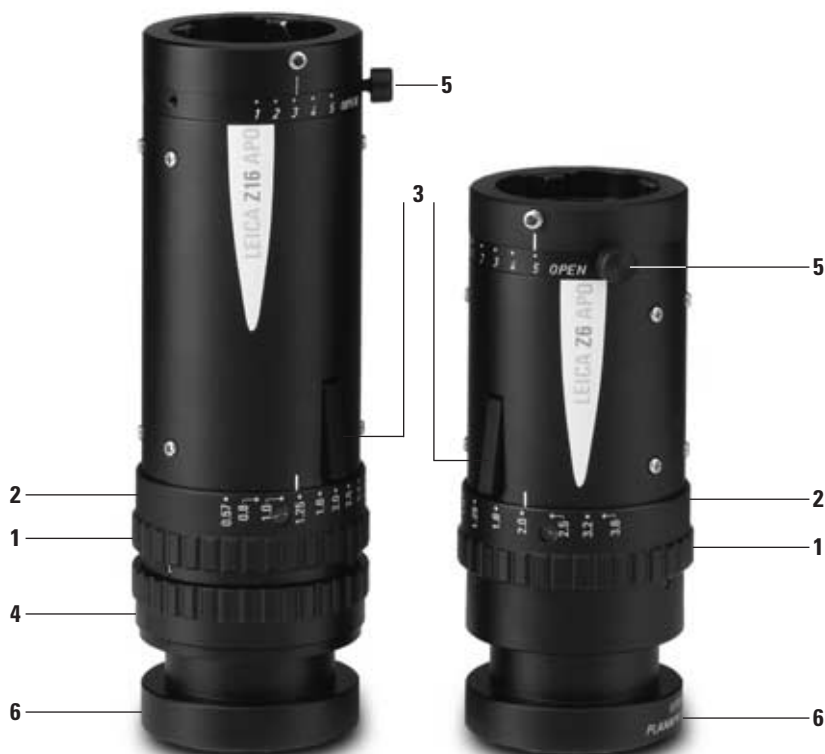
Fig. 12 Zoom, zoomlås: Til venstre zoomsystemet Leica Z16 APO med finfokusering og objektiv. Til højre zoomsystemet Leica Z6 APO med objektiv.
